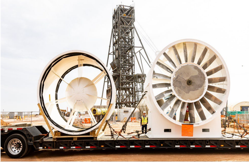
Los ventiladores que proporcionarán un mayor flujo de aire al subsuelo desde el pozo utilitario llegan al lugar
